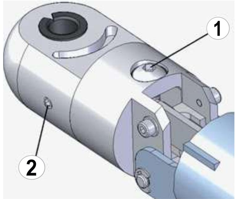
Mit der Einstellschraube lässt sich das Tray in seine radial-waagerechte Position ausrichten. Den Faltenbalg zurückziehen, bis die Einstellschraube (1) sichtbar ist.
