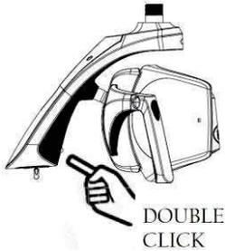
Jedes Mal, wenn ein Doppelklick ausgeführt wird, ändert sich der Tk-Wert der Leuchte. Wiederholen Sie den Vorgang, bis die gewünschte Farbtemperatur auf der Kontrollleuchte angezeigt wird. 2 Pieptöne informieren den Benutzer darüber, dass sich das Tk ändert.
